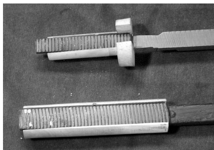
Om netjes te werken met kernspleetvijlen is het slim ze door een malletje te laten lopen dat precies op maat is gemaakt voor de boring van de kop van de blokfluit.
