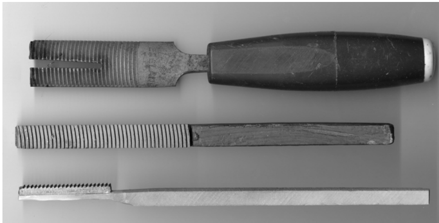
Van beneden naar boven: kernspleetvijl (zijaanzicht) voor sopraninoblokfluit; idem (bovenaanzicht) voor een alt; restant van een zgn. loodvijl waarin met de slijpschijf een gleuf is gemaakt.
