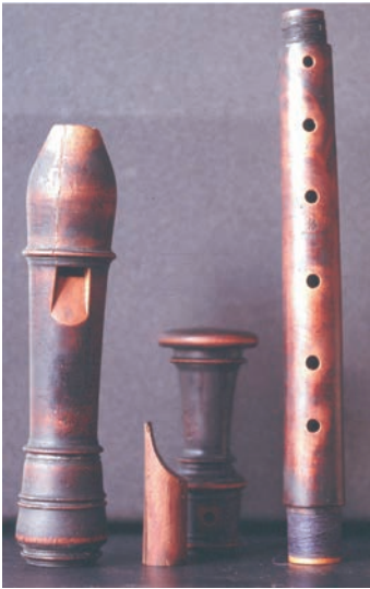
ABBILDUNG 1 Altblockflöte von Terton aus der Sammlung Boers, Rijksmuseum Amsterdam. Das Foto entstand 1981 in der Werkstatt eines Instrumentenbauers, der das Instrument für eigene Untersuchungen aus dem Museum ausgeliehen hatte. Die Flöte ist aus Buchsbaum gefertigt, die braune Farbschicht ist unregelmäßig abgenutzt, das Mittelstück ist deutlich verzogen, oben im Kopf ist ein durchgehender Riss sichtbar.
